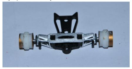
Utiliser les mors d'un étau pour monter à force les jantes sur l'essieu
